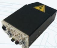
DC-DCコンバータは、高電圧のハイブリッドパワーバッテリー(900V)から、車両の電気系統に用いられている低電圧(12Vおよび48V)電力を発生させます。このコンバータは、高電圧SiC(炭化ケイ素)トランジスタを用いており、このトランジスタの高速スイッチングにより、わずか1.6kgのデバイスながら電力は2kWに達します。サステナビリティへの貢献のひとつとして、軽量かつ高効率を保證するこの技術は、ハイブリッド車で活用されています。
