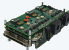
することが可能になります。非常に小型のフォームファクタであるため、この電子パワーデバイス2台を統合し同じ冷却システムとパッケージを共有することにより、極めて軽量かつ高効率なユニットが実現できます。また同製品を、350kWの6相EVトラクションモーターに電力を供給するように構成することもできます。
